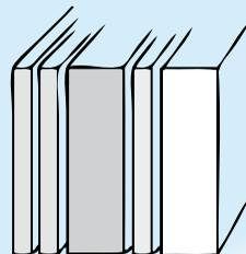
Esempio pacchetto: configurazione a 3 lastre di cartongesso e 2 fogli di fibra di poliestere termolegata
